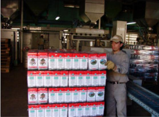
Los productos finales deberán ser almacenados y manipulados en condiciones que impidan su deterioro. Se debe controlar la altura de las pilas o pallets y evitarse que los elevadores de carga dañen el producto.
