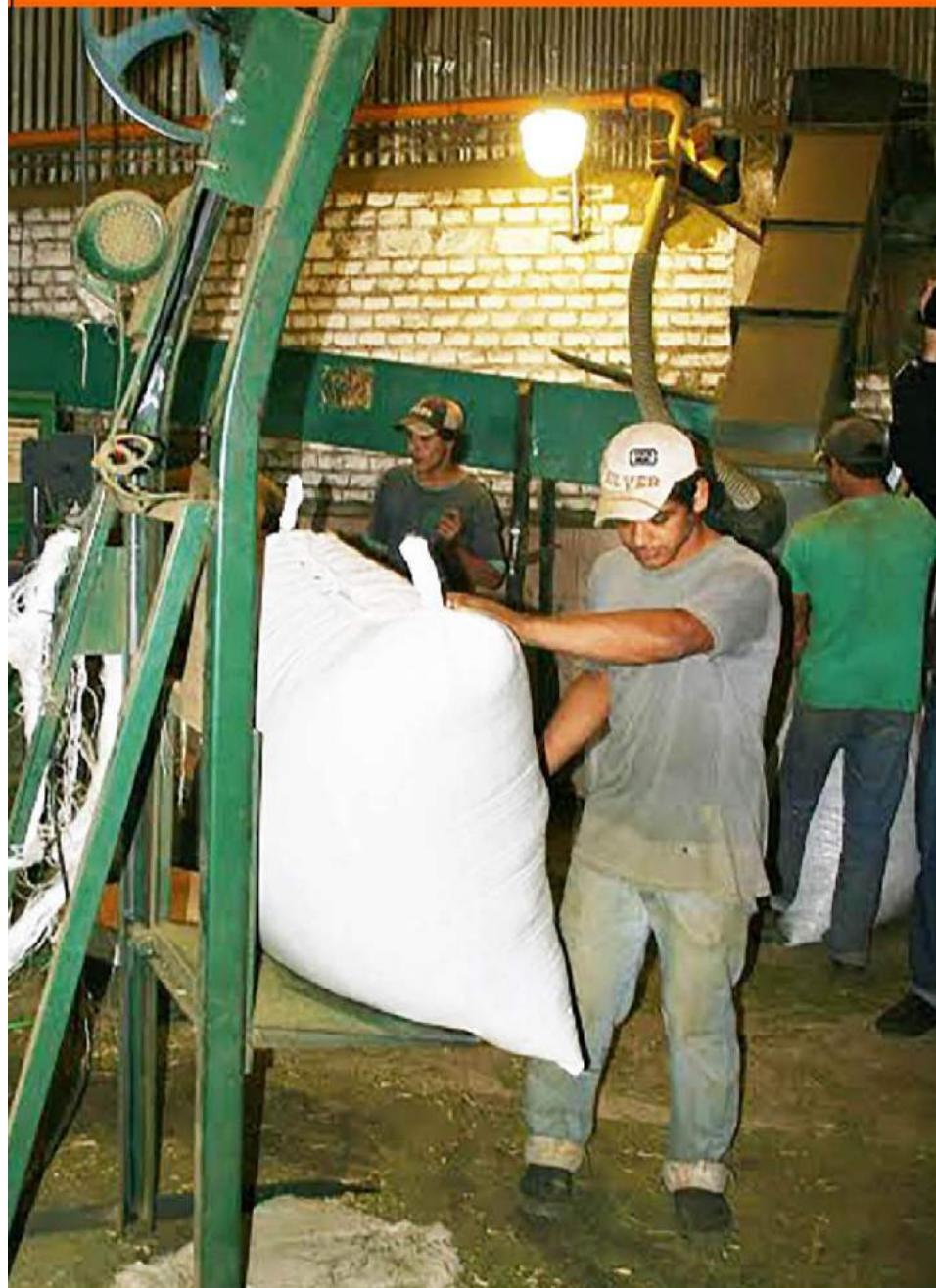
equipo de pulsador de bolsas u hombreador mecánico, dada su utilidad para facilitar el pesado trabajo de levantar las bolsas de yerba mate al hombro de los operarios, elevándolas de forma automática, sin esfuerzo o reducido a su mínima incidencia, evitando las lesiones de los trabajadores".
